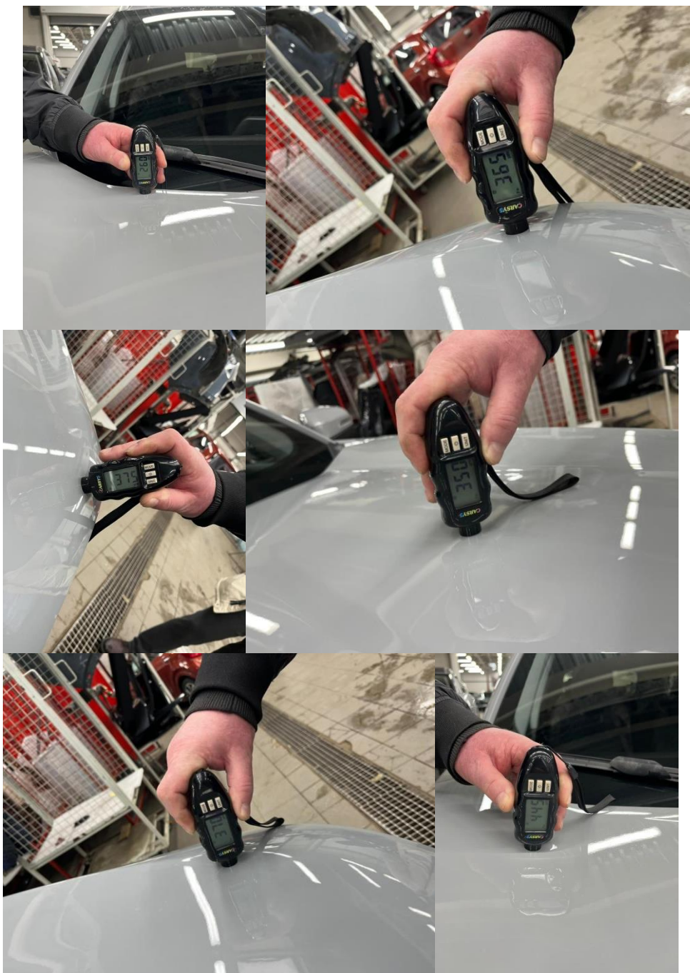
Иллюстрация №2 – капот окрашен с превышением толщин вторичного окраса
