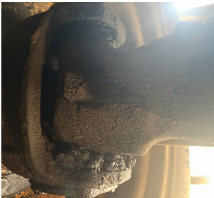
Иллюстрация №4– течь масла переднего моста
