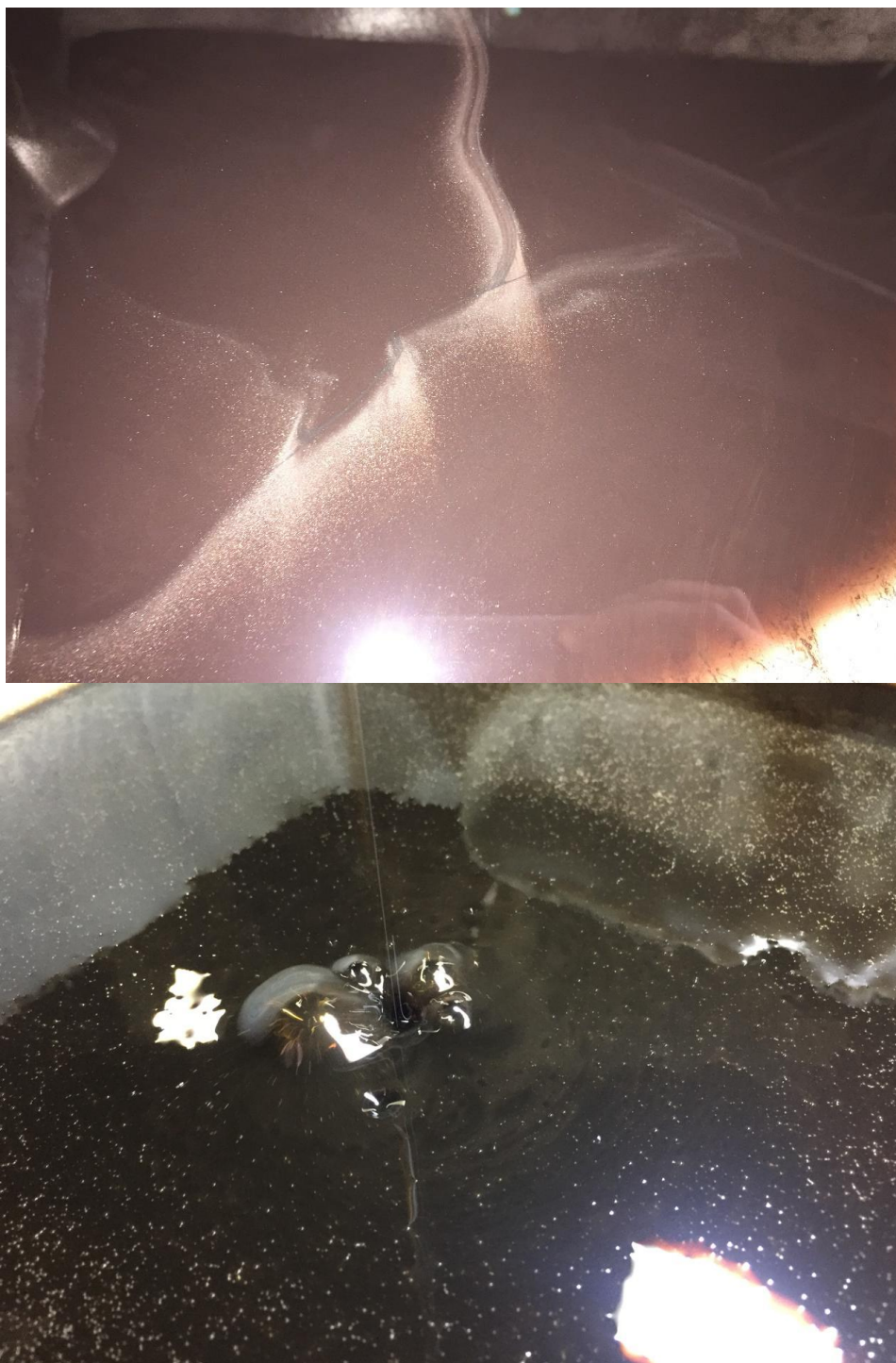
Иллюстрация №4 – металлическая стружка в моторном масле
